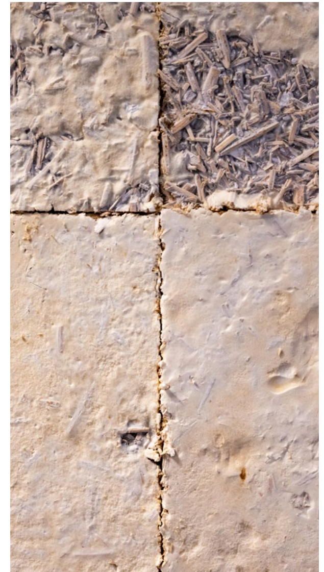
Foto: Detail van een biobased mycelium plafondpaneel. (Fotograaf: Hugo de Wolf).*
