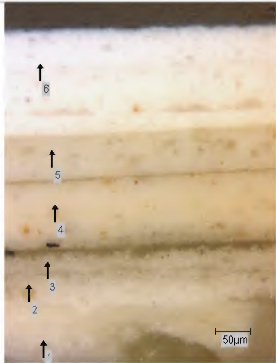
Verfdwarsdoorsnede SAEK-M01, de onderste lagen zijn kalklagen (2-3)
