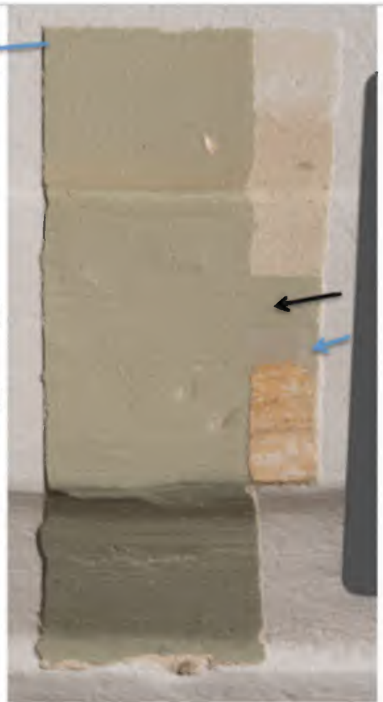
De blauwe pijl geeft het grijsblauwe afwerkstadium aan . De zwarte pijl het grijsgroene afwerkstadium.
