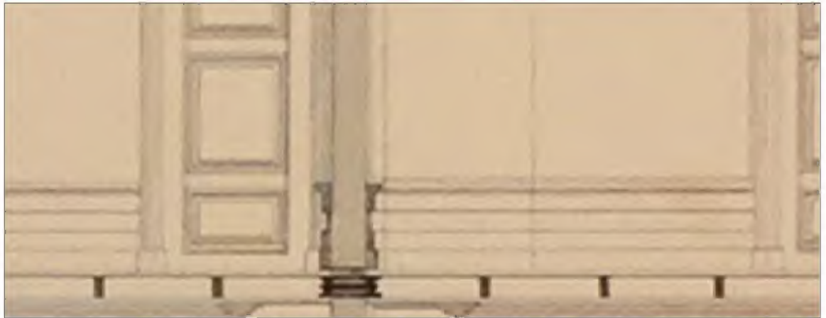
Afb. 3.152 en afb. 3.153 Details uit doorsnedetekening A-B uit 1859 over een vertrek op de 2e (of 3e) verdieping met strokenlambrisering.
