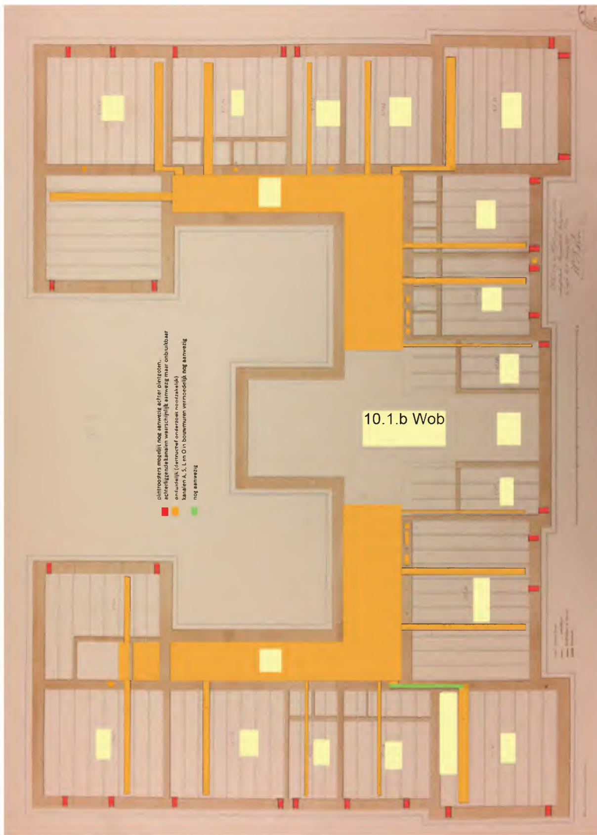
Afbeelding 4.34. Vloerplan van de eerste verdieping, met aangeduid de verschillende onderdelen van het verwarmings- en ventilatiesysteem in de huidige situatie (bestektekening 1859, bewerkt door 10.2.e Wob)
