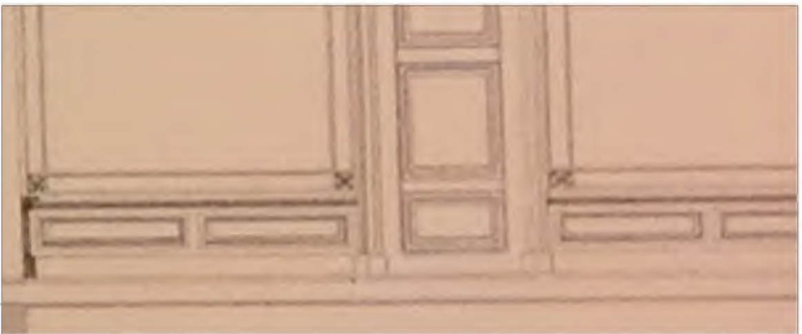
Afb. 3.154 en afb. 3.155 Details uit doorsnedetekening A-B uit 1859 over een vertrek op de 1e verdieping met paneellambrisering.
