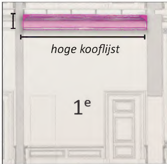
Afb. 3.64: Detail uit oorspronkelijke doorsnedetekening over een vertrek op de 1e verdieping. Op deze verdieping hebben de plafonds hoge kooflijsten rondom.
