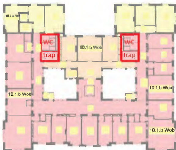
Afb. 302: De extra trappenhuisen en de toiletblokken uit 1979 zijn geplaatst in de ruimtes die sinds de uitbreidingen van 1883 en 1895 volledig inpandig waren geworden.
