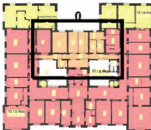
Afb. 3.62: Plattegrond van de begane grond anno 2021, met aanduiding van de diverse bouwdelen en specifiek de uitbreiding uit 1883, welke lichtoranje is gekleurd en met een zwart kader is aangeduid.
