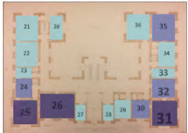
Afb. 3.66: Bestektekening uit 1859 van de 1e verdieping, met daarin door Bureau Bouwtijd aangeduid de nummers én de hiërarchie van de ruimtes: hoe donkerder, hoe chiquer het interieur was afgewerkt.
