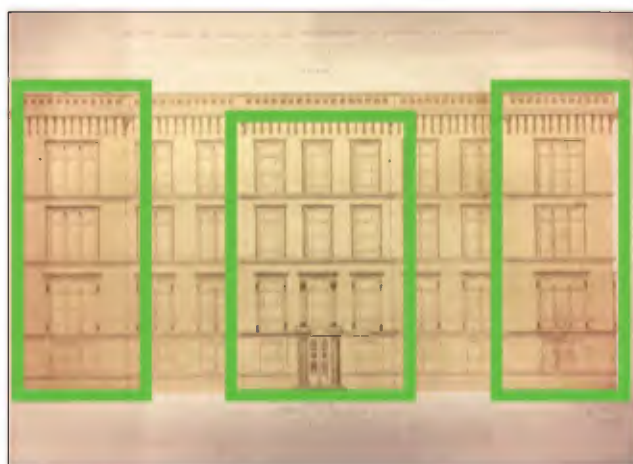
Afb. 2.41. Rose's definitieve gevelontwerp voor het 'Nieuwe Koloniën' (1859) vertoont nog steeds de gevelindeling met midden- en hoekrisalieten (groen aangegeven). De dubbele bordestrap, frontons en beelden zijn echter verdwenen. Verder is er een volwaardige 3e verdieping toegevoegd, en zijn de lage daken verstoep achter een hoge attiek. (Bron: NA, 781)
