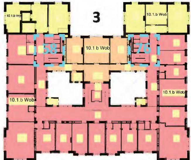
Afb. 2.128.: Plattegrond van de huidige situatie op de 3e verdieping met daarin aangegeven de drie verschillende bouwdelen: het oorspronkelijke gebouw uit 1861 (lichtrood), de uitbreiding van 1883 (lichtoranje) en de uitbreiding van 1895 (lichtgeel).
