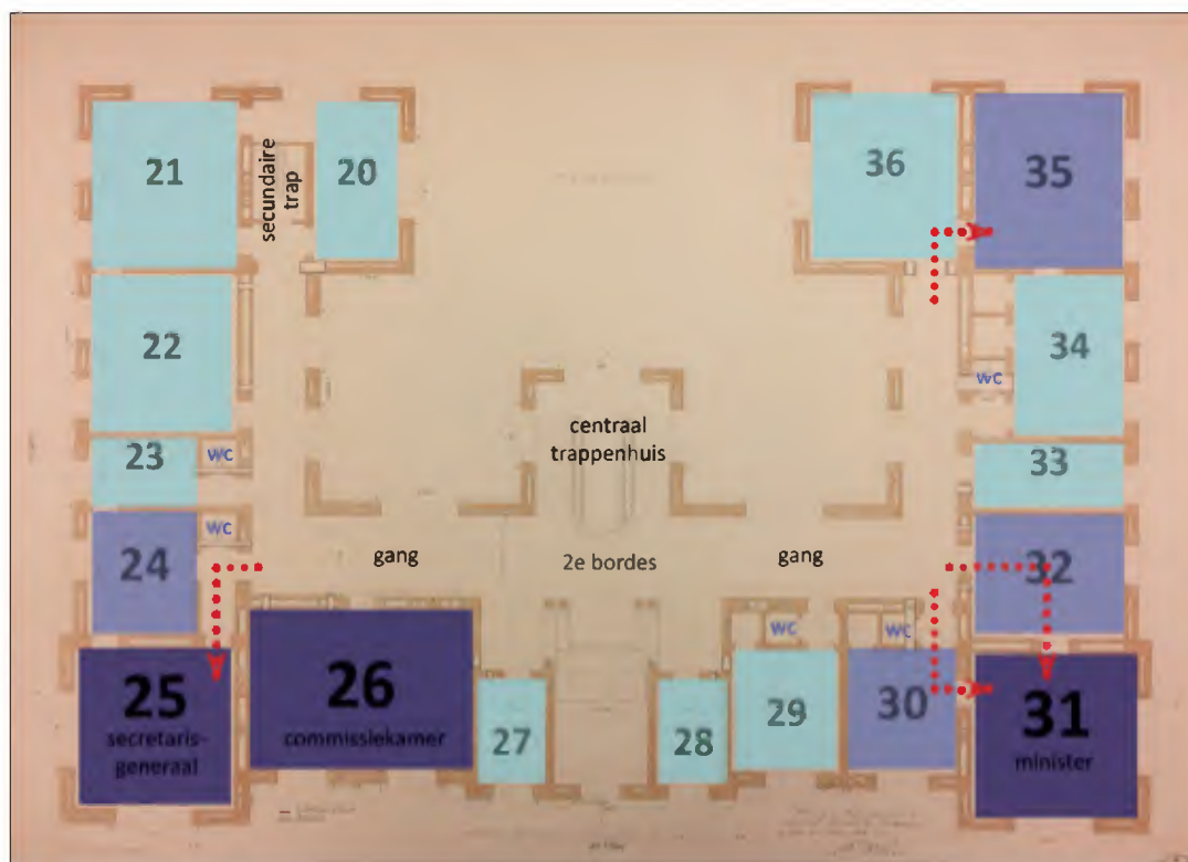
Afb. 2.76: In het bestek zijn foutief N°36 en N°35 van categorie verwisseld. Hierboven is de correcte oorspronkelijke hiërarchie op de eerste verdieping aangegeven door Bureau Bouwtijd. Hoe donkerder de kamer is gekleurd, hoe meer status deze had (zie ook tabel xx). Ook is met rode stippellijnen aangegeven dat vertrekken N°s 25, 31 en 35 alleen te bereiken waren via een ander vertrek (Bron: NA, 4.RGD, inv.nr. 530).
