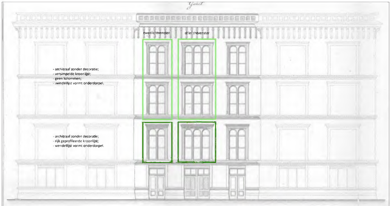
Afb. 3.5: Achtergevel van de uitbreiding uit 1883 volgens de bestektekening. Aangeduid de twee hier toegepaste venstertypen en de hiërarchie in de decoratie rond de vensters (bron: Het Nationaal Archief, bewerking 10.2.e Wob)
