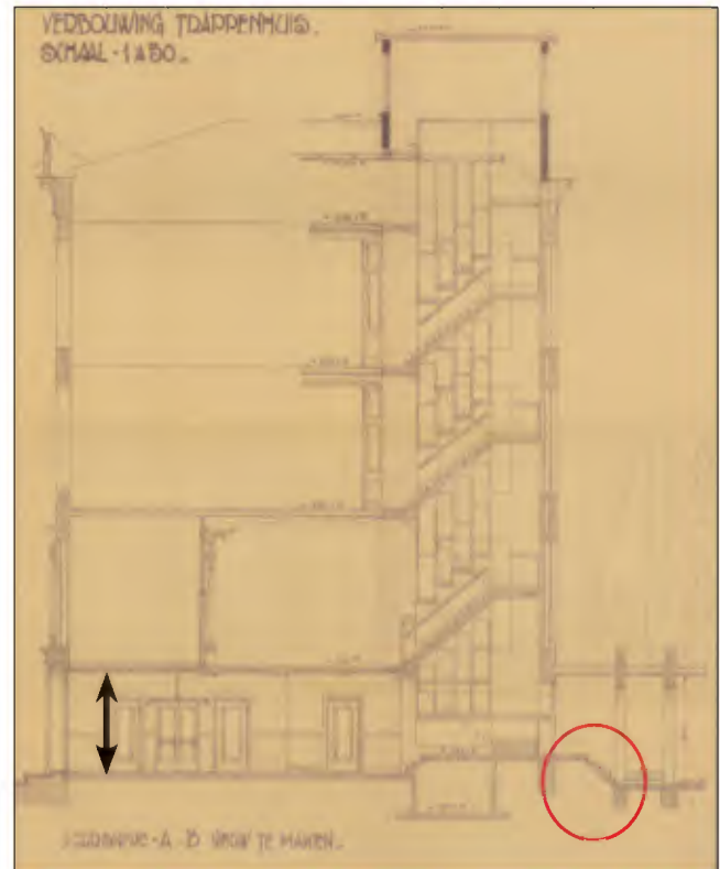
Afb. 2.256: Doorsnede van de nieuw te maken vestibule in 1931 (Bron: RVB collectie).
