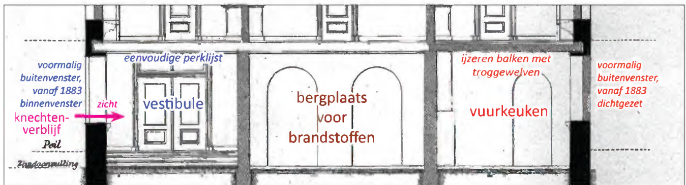
Afb. 3.56: Detail van doorsnede uit 1883 over de begane grond van de nieuwe uitbreiding. Aangeduid zijn de functies van de ruimtes, de plafondafwerking en wat er met de twee buitenvensters van het oorspronkelijke gebouw gebeurde, die door de aansluiting inpandig werden.
