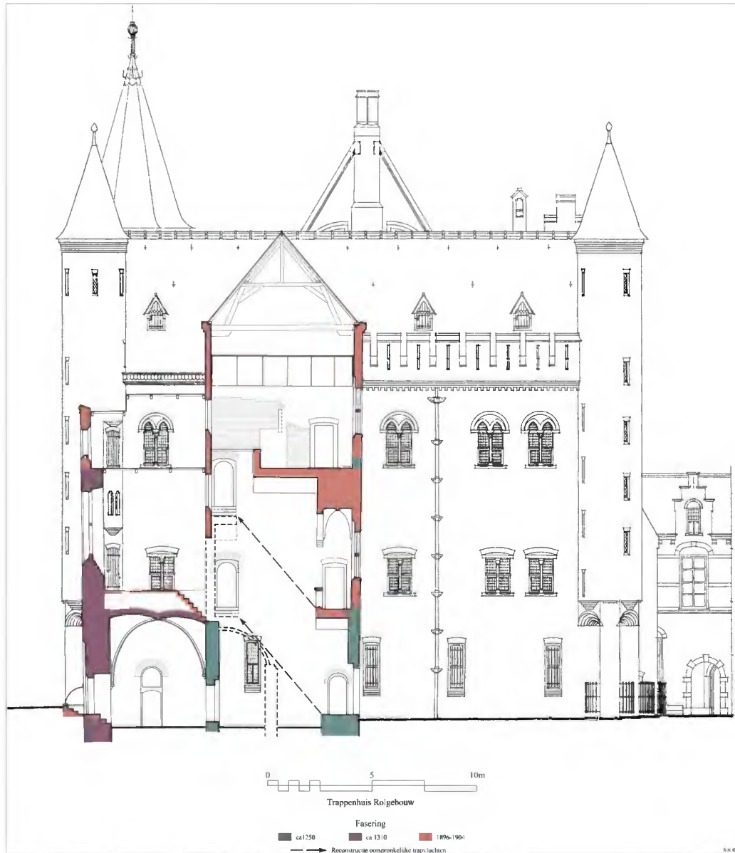
Afb. 44. Aanzicht van de oostgevel van het Rolgebouw met de langsdoorsnede van het uitgebreide trapportaal. De verschillende bouwfasen in kleur. Met gestippelde pijlen zijn de oorspronkelijke trapvluchten in het trapportaal aangegeven. Bovenin het trapportaal de kapelruimte met zicht op het oorspronkelijke metselwerk met het bouwpoor van een hoog smal venster, een zogenoemde squint.
