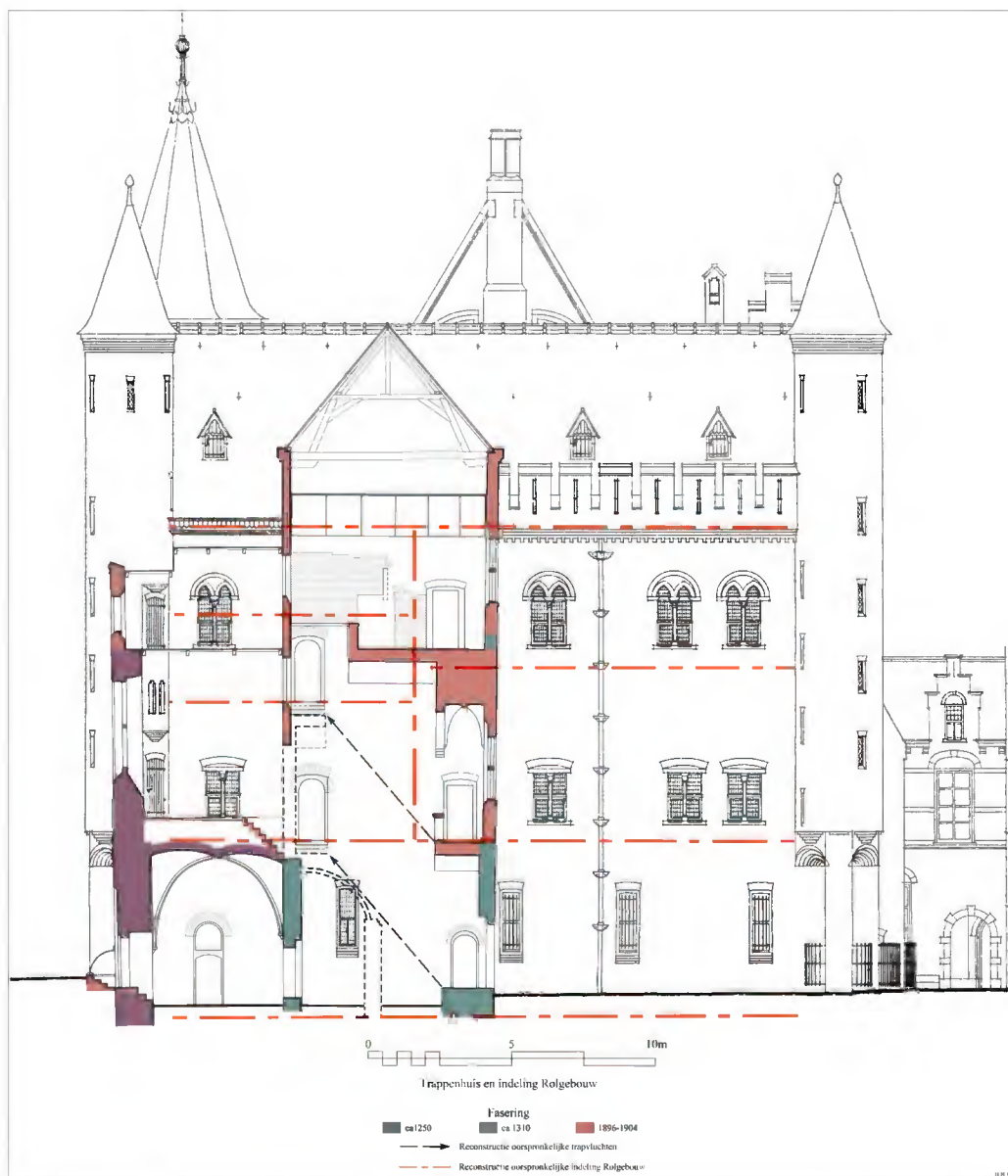
Afb. 29. Aanzicht van de oostgevel van het Rolgebouw, met de doorsnede van het uitgebouwde trapportaal. Met een rode streep-stippellijn is de oorspronkelijke indeling van het Rolgebouw weergegeven. Met een zwart gestippelde pijl de oorspronkelijke trapvluchten in het trapportaal.
