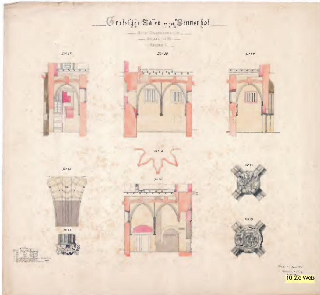
Afb. 92. Documentatietekening uit april 1898 van de kelder het De Lairessegebouw uit 1330. De kelderruimte is aangebracht ter plaatse van de binnenplaats tussen het De Lairessegebouw uit 1310 en het trapportaal uit 1250 van het Rolgebouw. De kelderruimte is voorzien van een tweetal kruisribgewelven met geprofileerde tufstenen consoles en sluitstenen met bladmotieven. Met een oranje kleur (doorsnede muurwerk) en beige kleur (aanzicht metselwerk) is het oorspronkelijke metselwerk uit 1310 en van de verbouwing van 1330 van het De Lairessegebouw aangegeven. Met een rode kleur het jongere, veelal zeventiende-eeuws metselwerk. Een donker en licht bruine kleur geeft het oorspronkelijke metselwerk uit 1250 van het trapportaal van het Rolgebouw weer. Beeldbank RCE, inv.nr. BT-019135.
