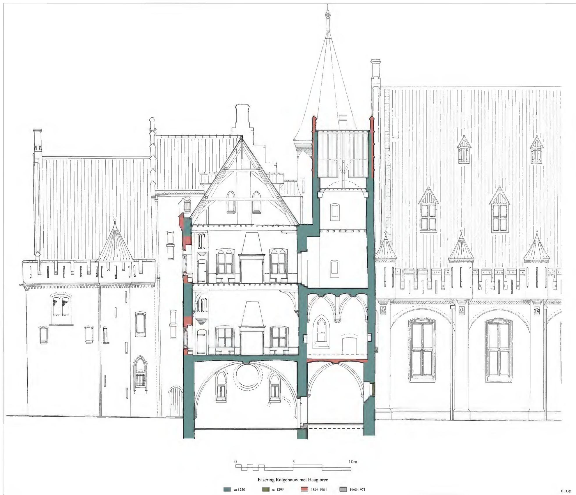
afb. 39. Doorsnede van het Rolgebouw richting het zuiden met Haagtoeren. De verschillende bouwfases in kleur.
