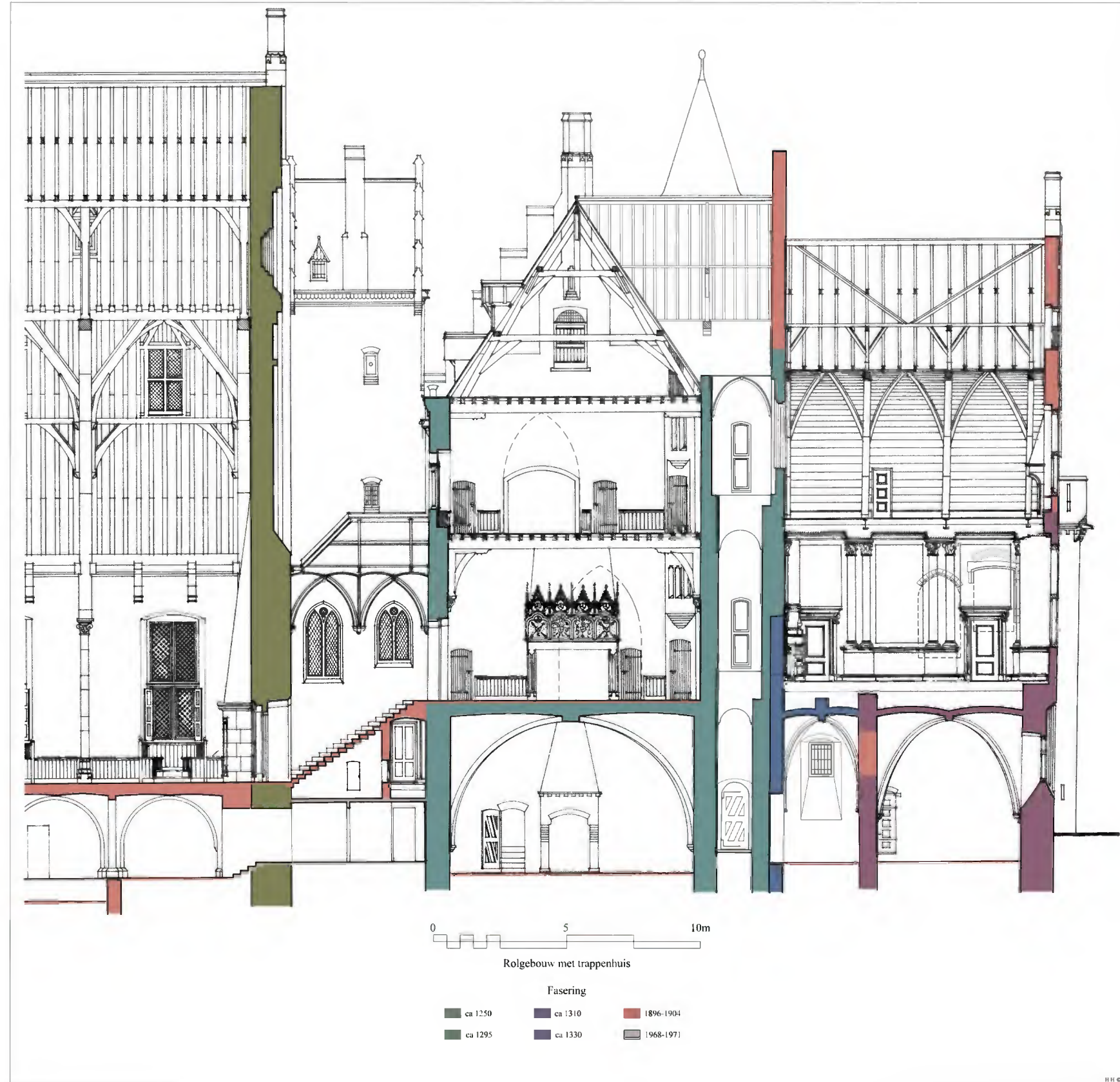
Afb. 40. Doorsnede van het Rolgebouw richting het noorden met het trappentaal. De verschillende bouw fasen in kleur.
