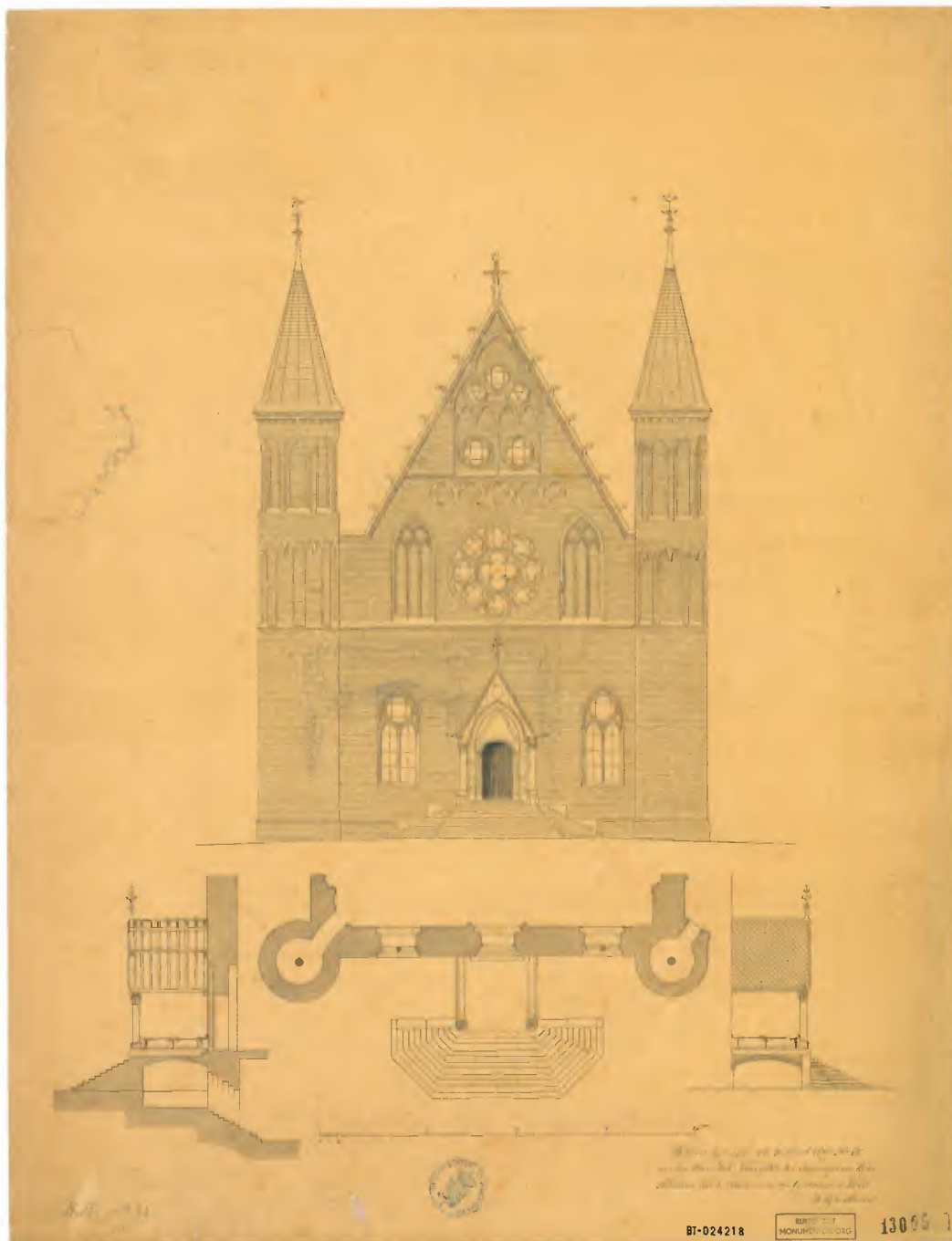
Afb. 75. Tekening restauratievoorstel westgevel Grote Zaal uit 1877. De torens krijgen een nieuwe bekroning en de entree een voorportaal met bordestrap. Het roosvenster en de twee spitsboogvensters worden voorzien van natuurstenen traceringen evenals de spitsboognissen links en rechts van het roosvenster. Beeldbank RCE, inv.nr. BT-024218.
