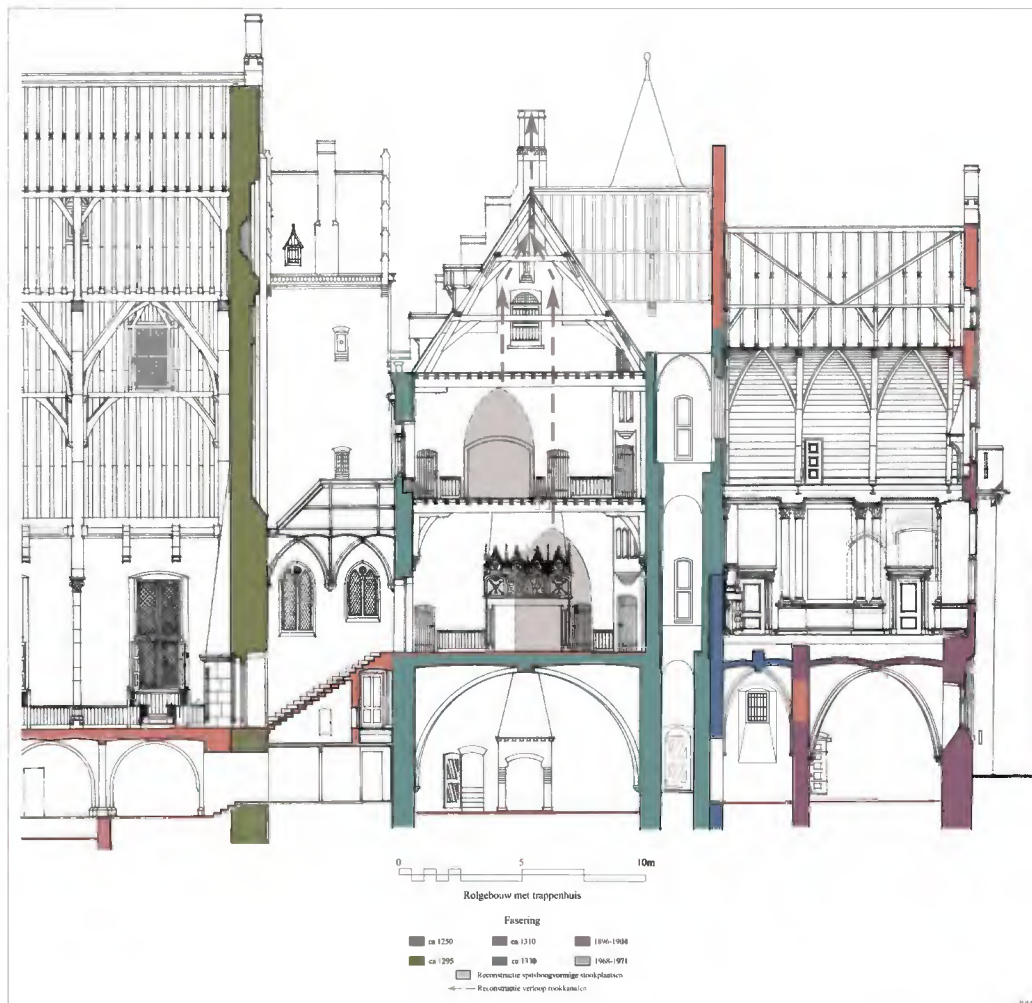
afb. 42. Doorsnede van het Rolgebouw richting het noorden, met trapportaal. De verschillende bouwfasen in kleur. In de kopse noordgevel zijn de ingekleurde spitsboogvormige schouwen van de Rolzaal (bel-etage) en van de Weeszaal op de erboven gelegen verdieping weergegeven. Met gestippelde pijlen is het verloop van de rookkanalen aangegeven. De oorspronkelijke koningszaal (nu kelderzaal) was oorspronkelijk onverwarmd en de huidige schouw in historiserende stijl tegen de noordgevel van de zaal is een product van de restauratie van 1900.
