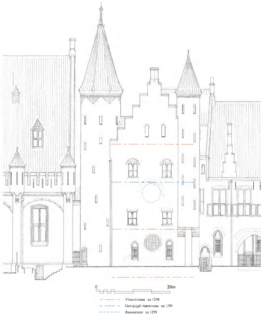
Afb. 54. Zuidgevel van het Rolgebouw waarin met een rode streepstijp, in de vloerniveaus uit 1250 en met een blauwe streepstijp, in de in 1295 gew. jzige vloerniveaus z. jn aangegeven. Met een blauwe stijp, in is het eveneens in 1295 aangebrachte roosvenster weergegeven van de vergrootte Rolzaal.
