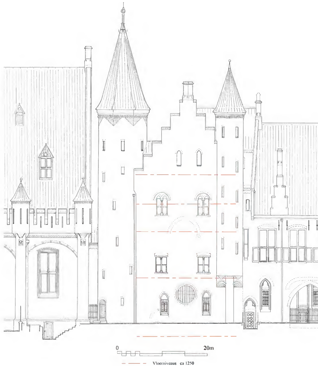
Afb. 53. Zuidgevel van het Rolgebouw waarin met een rode streepstijpelling de oorspronkelijke vloerniveaus uit 1250 zijn aangegeven. Het betreft het vloerniveau van de koningszaal, het voorvertrek van de 'Rolzaal', de twee bovenliggende woonvertrekken waarvan de onderste een tussenverdieping betreft en de zolderverdieping.
