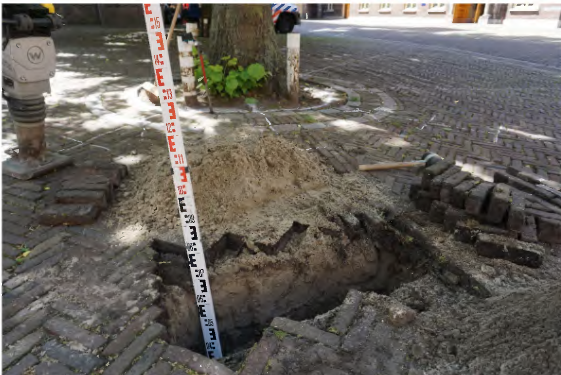
Foto 9: Bodemprofiel op 3,0 meter afstand, cunet is 30 cm, daarna humusarm fijn zand met fijn puin. Extensief doorworteld bodemprofiel met 2 wortels van 3 cm doorsnede waarvan 1 afgestorven.
