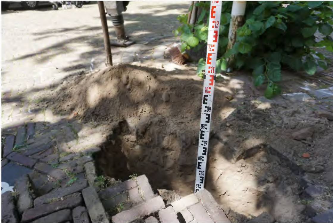
Foto 12: Profielsleuf aan de zuidzijde van boomnummer 4 op 2,8 meter uit hart stam, het bodemprofiel is matig intensief doorworteld met wortels tot 3 mm doorsnede.
