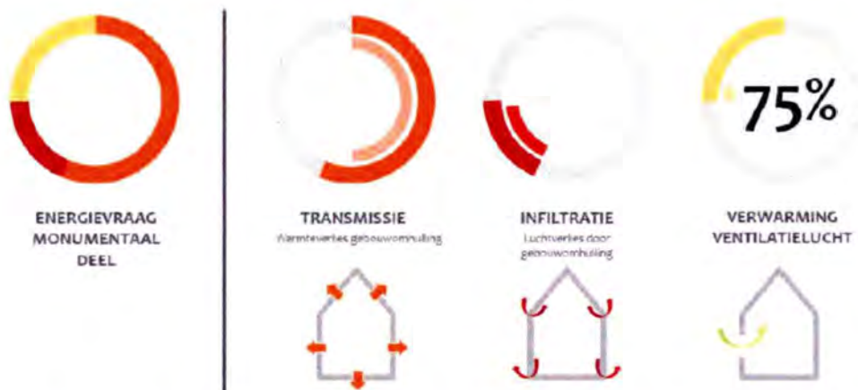
Figuur 7: Aandeel componenten in reductie verwarmingsvraag en potentie na besparing (binnencirkel)
