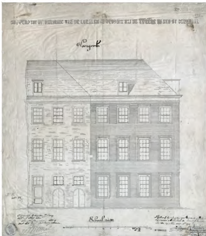
151 Tekening van de gevel van de uitbreiding in de vorm van een bouwdeel met vier vensterassen aan de zijde van de Hofsingel naar ontwerp van Singels, 1877. Het linker (bestaande) deel op de tekening is het in 1789 toegevoegde deel van de Dienstvleugel, nog met twee toegangen met rondbogen. (Herkomst: Beeldbank RCE, inv. nr. BT-006323)
