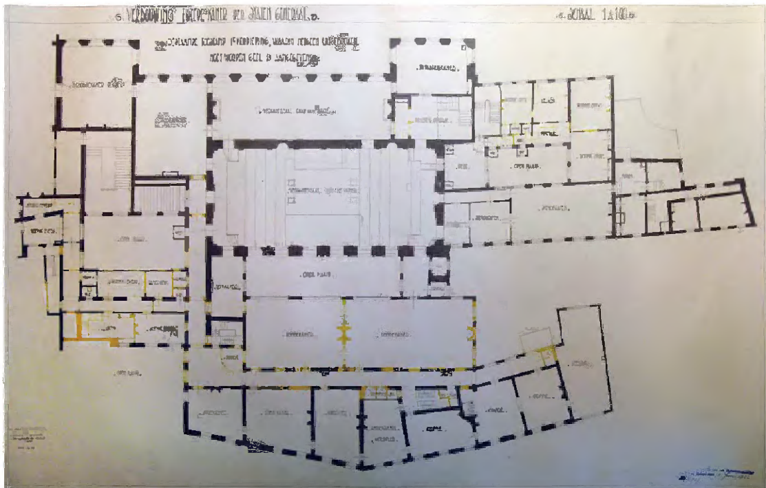
192 Tekening van de eerste verdieping uit 1922, waarop in geel is aangegeven wat wordt uitgebroken. Het noorden is boven. (Lit. Heijnenbrok & Steenmeijer 2011a)
