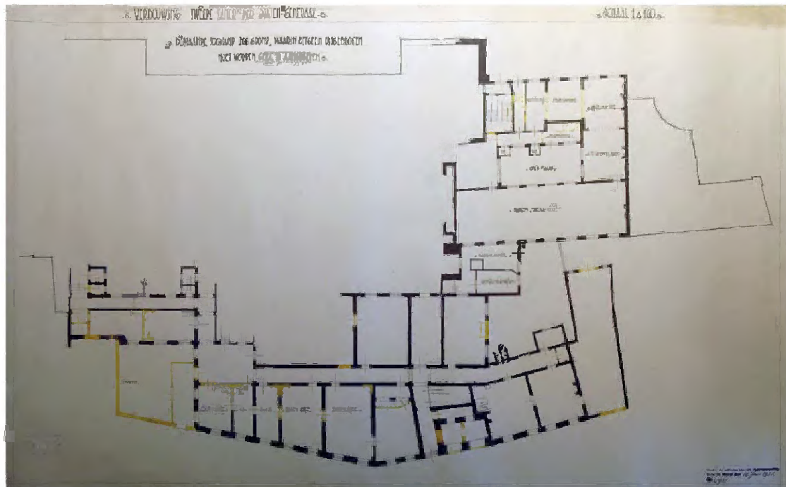
190 Tekening van de begane grond van de Dienstvleugel uit 1922, waarop in geel is aangegeven wat wordt uitgebraken. Het noorden is boven. (Ul. Heijens & Steenmeijer 2011a)
