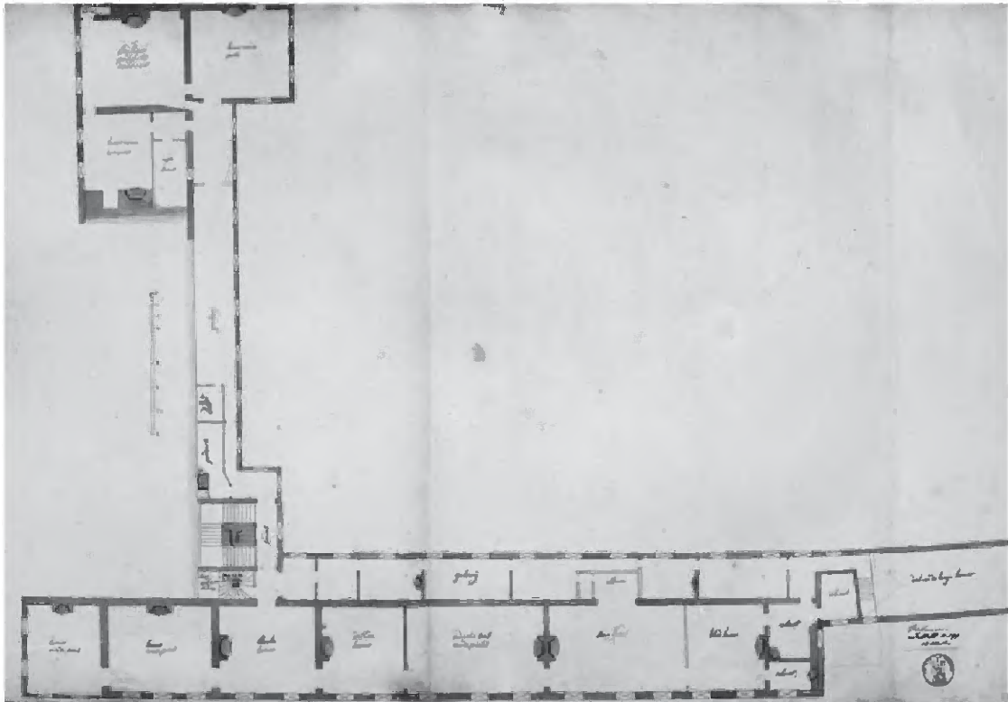
75 Plattegrond van de tweede verdieping van het oude Stadhouderskwartier met links de vleugel aan de Hofvijver. Op de plaats van de maatstok is bewust niet aangegeven de in 1652-1657 gebouwde vergaderzaal van de Staten van Holland (nu vergaderzaal Eerste Kamer). Uiterst rechts het dak van de lange kamer. Het noorden is links. (Herkomst: NA)
