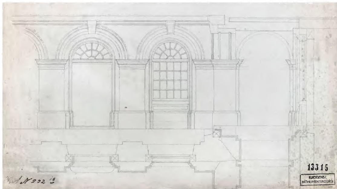
104 Deel van de gevel van de begane grond van de galerij met horizontale en verticale dwarsdoorsnede. (Herkomst: Beeldbank RCE; inv. nr. 18, AT-0036)
