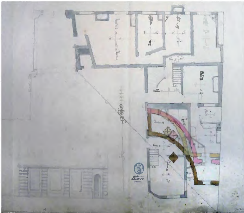
73 Plattegrond uit circa 1779 met ingetekend de zichtlijn vanaf het Binnenhof op de Hofpoort en met in kleur ingetekend twee varianten van de nieuwe bebouwing. De variant in bruin, waarbij ook de plaats van de pomp is aangegeven, werd uiteindelijk gerealiseerd. (Uit: Heijenbrok & Steenmeijer 2012)
