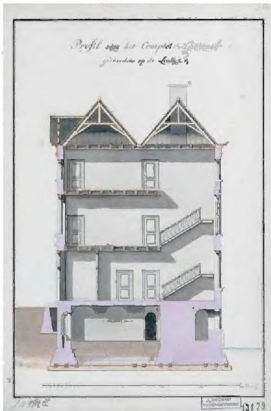
65 Doorsnede van het Comptoir-Generaal over de lijn L-F (de ingang en de trap). De voorgevel is links. (Herkomst: Beeldbank RCE; inv. nr. AT-001/VAN 246-11)
