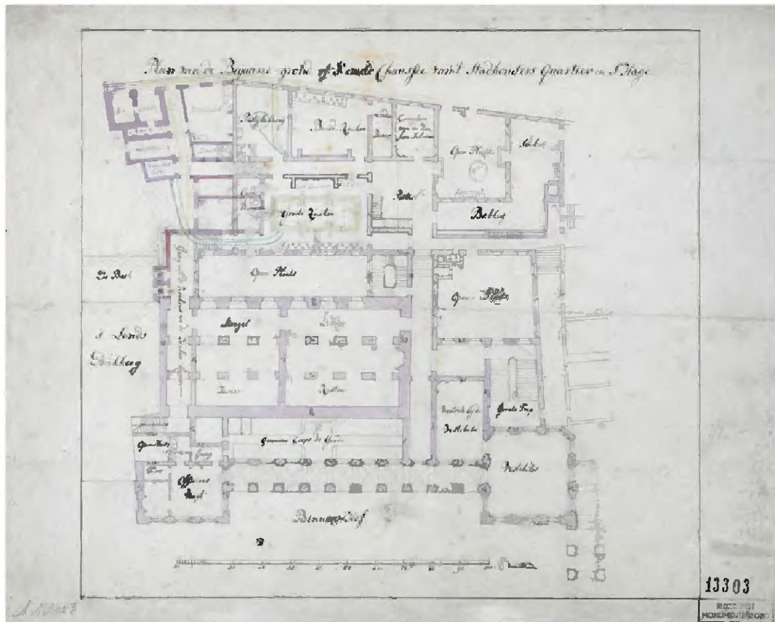
89 Plattegrond van het souterrain (vermoedelijk uit 1777) met links de uitbreiding op het aangekochte terrein waar zich de keuken en het hoenderhok bevinden. Boven in het midden de 'Braad-keuken' en de 'Grote keuken'. De gang hiertussen is nog steeds een structurerend element in de binnensteugel. Het noorden is onder. (Herkomst: Beeldbank RCE; inv. nr. 232-2, AT-0020)
