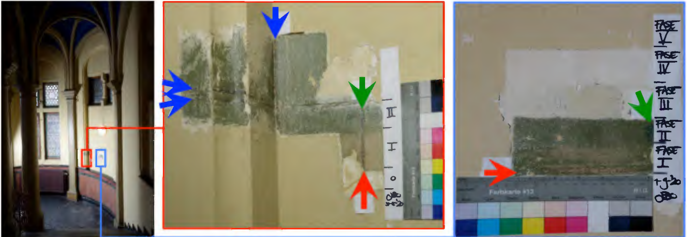
54. locatie kleuronderzoek rondboog en wand, vestibule trappenhuis, J.03.1.30, met rode en blauwe rechthoeken aangegeven door auteur 55. detail doorlopende kijkvenster wand, paarsbruine biezen met blauwe pijlen en groene sjablonering met groene pijl aangegeven door auteur 56. detail kleurtrap wand, rode bies met rode pijl en groene sjablonering met groene pijl aangegeven door auteur, foto's auteur
