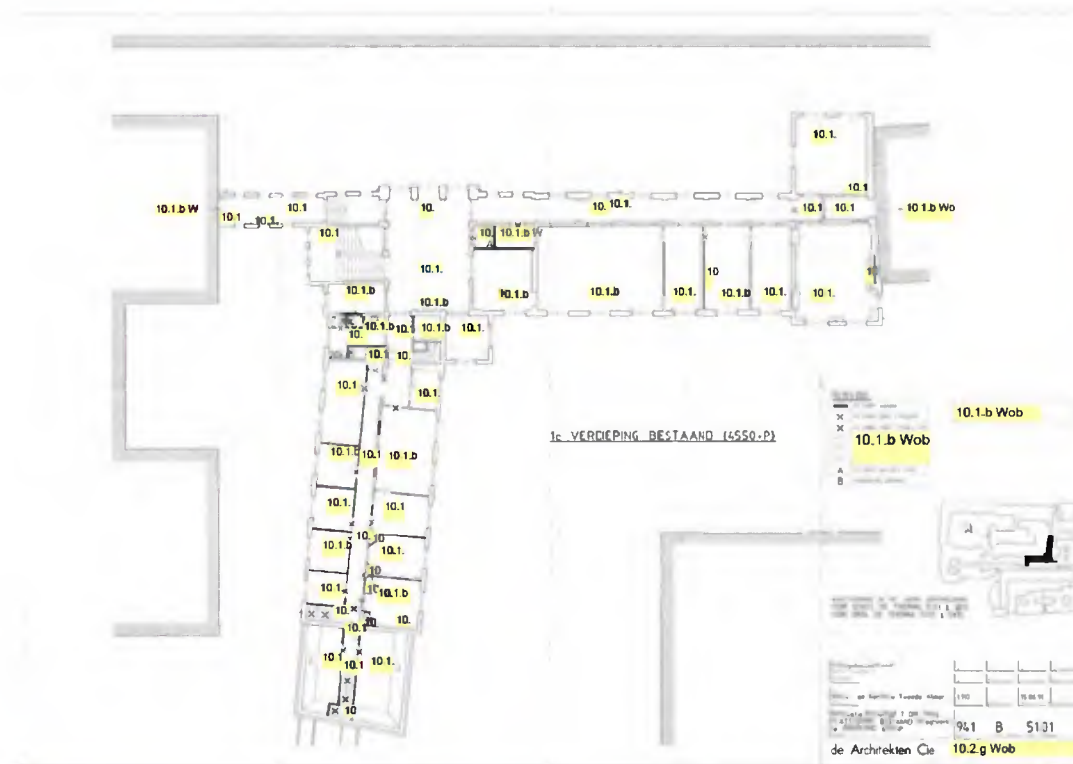
Tekening van de eerste verdieping in 1998 met daarop aangegeven de te slopen delen, voornamelijk bij de toiletten en de trappen in de oostvleugel. (Herkomst: Archief Rijksvastgoedbedrijf)
