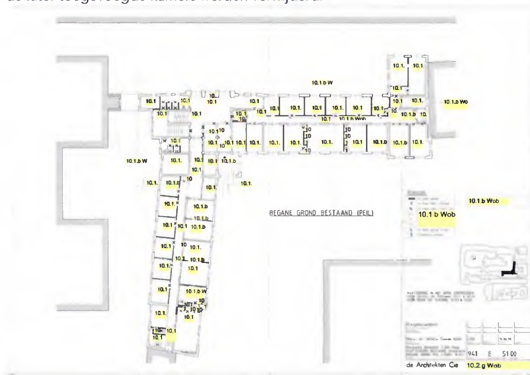
Tekening van de begane grond in 1998 met daarop aangegeven de te slopen delen, voornamelijk bij de toiletten en ter plaatse van de ingebouwde kasten. Ook worden de kamers uit 1953 in de zuid-vleugel weer verwijderd. (Herkomst: Archief Rijksvastgoedbedrijf)
