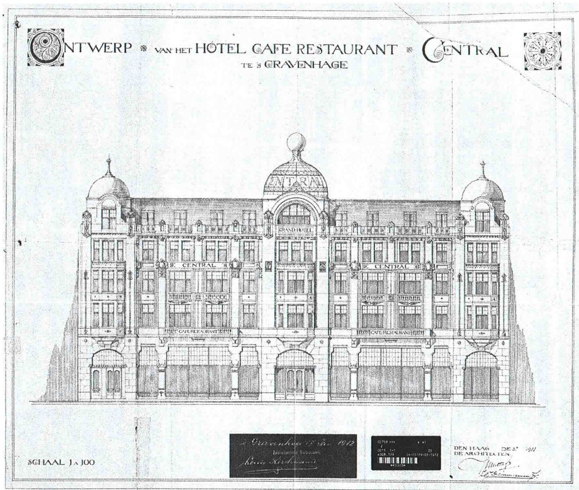
51. Ontwerptekening van de voorgevel aan de Lange Poten uit 1912. In dit ontwerp zijn de vensters in de kapverdieping verdiept in het dakvlak aangebracht in plaats van als dakkapellen (RVB Rgd-archief 431835).
