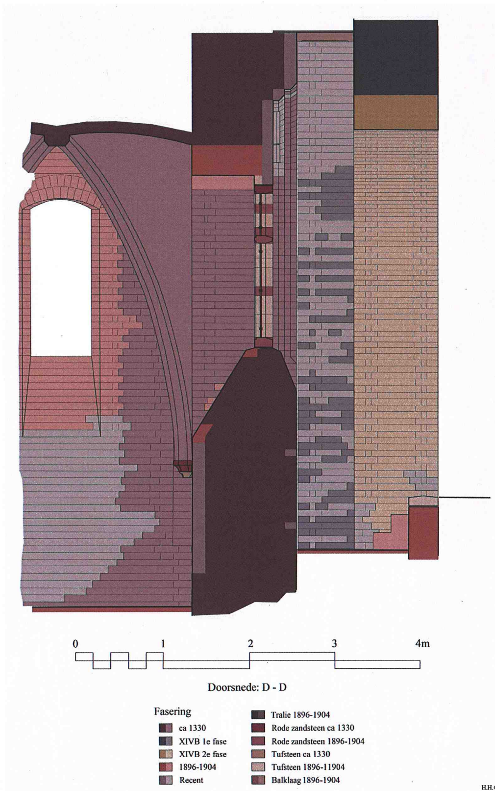
Afb.27. Doorsnede D-D van de zuidelijke gevel van de oostelijke kelder onder de De Lairessezaal. In kleur de verschillende bouwfases en materialisatie.
