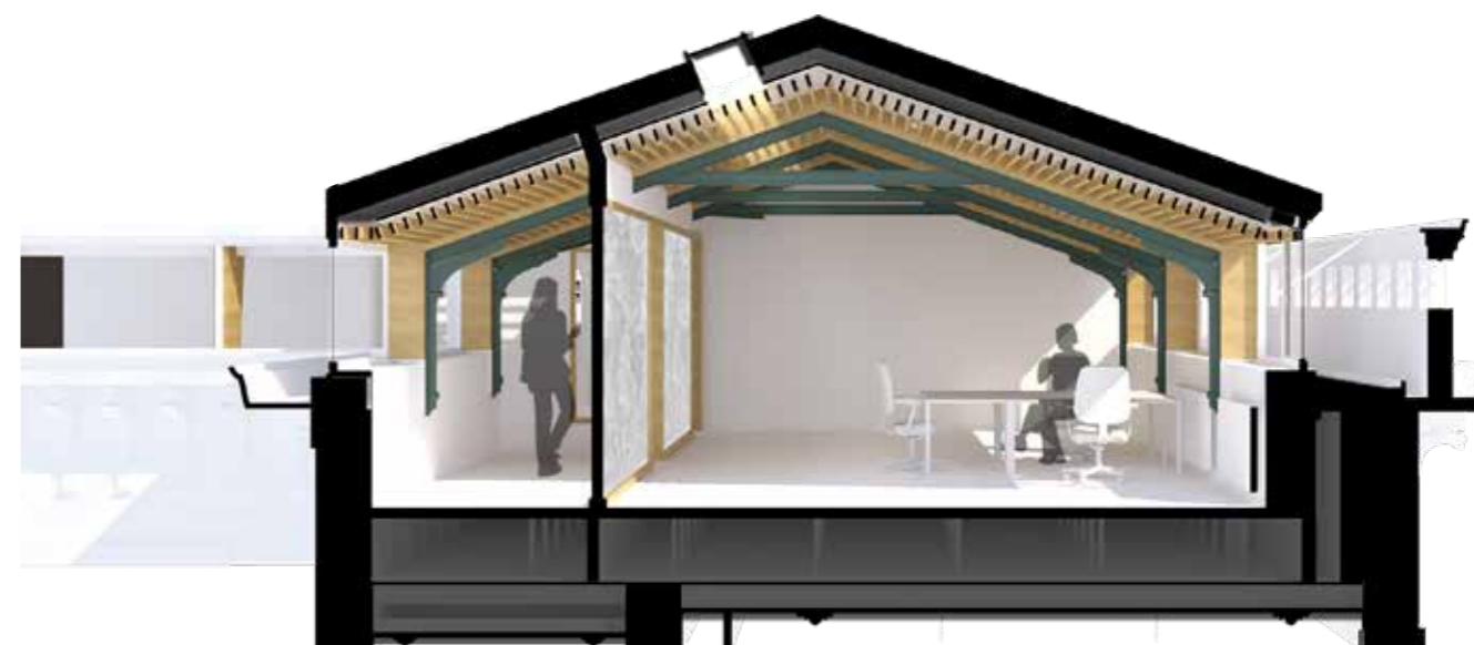
Vernieuwd dak Koloniën
